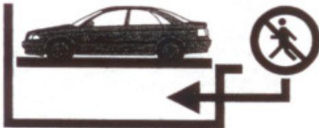
Zur Reinigung der Gruben müssen die Anlagen zwingend mechanisch gegen Absinken gesichert werden.
